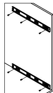
Fixe a parte 3 das corrediças na lateral do móvel utilizando os parafusos(C).
