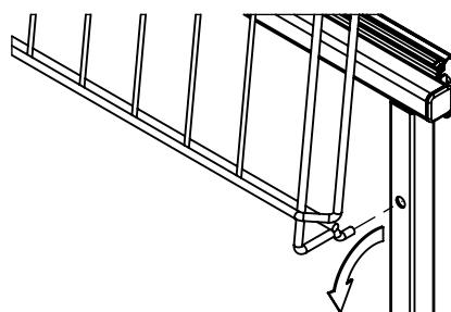
Finalize montando o aramado(A) no quadro(B), inserindo a ponta do arame no furo e girando para baixo até encaixar.
