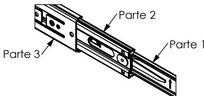
Desmonte as corrediças utilizando a alavanca de separação.
