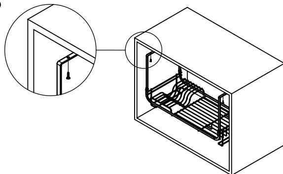
Posicione o Porta Pratos(A) no local de instalação e fixe-o utilizando os Parafusos(C).
