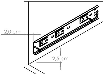
Posicione a corrediça - Parte A(B) no móvel, mantendo um afastamento mínimo de 2,0 cm da frente e 2,5 cm da base. Fixe utilizando os parafusos(D).
