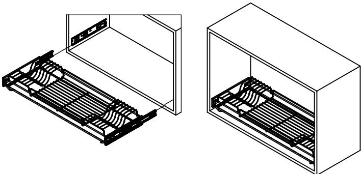
Posicione as corrediças dos dois lados e empurre até encaixar completamente, conforme demonstrado acima.
