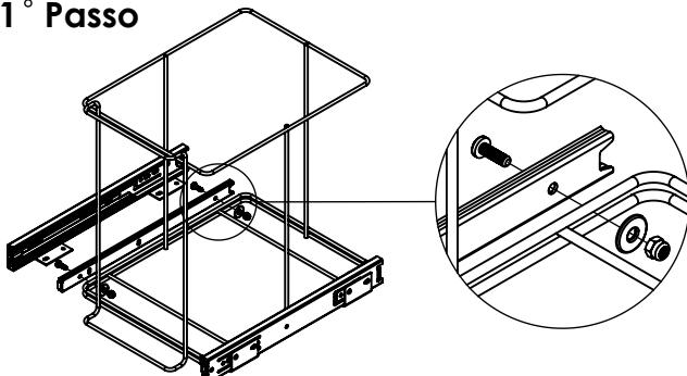
Fixe as Corrediças(C) ao Aramado(A) utilizando os Parafusos(F), Arruelas(G) e Porcas(H).
