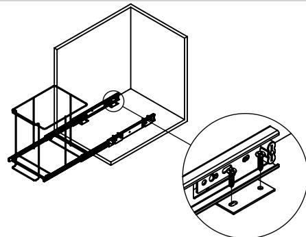
Posicione o conjunto alinhando a frente do Aramado(A) com a frente do móvel, puxe o Aramado(A) para fora e fixe as Corrediças(C) utilizando os Parafusos(E).
