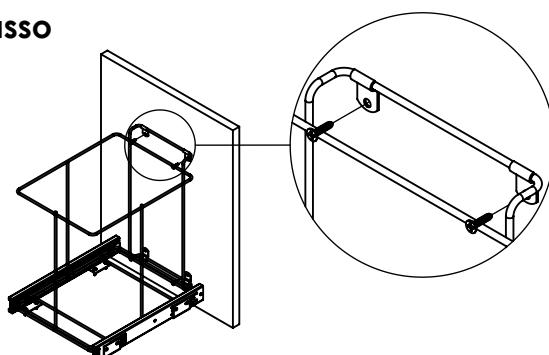
Se desejar, fixe o Aramado(A) ao tampo do móvel utilizando as Presilhas(D) e os parafusos(E).
