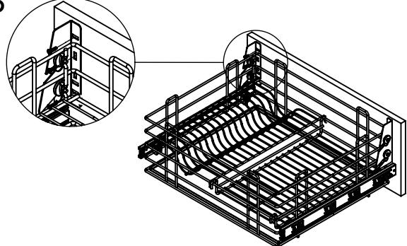
Fixe os Suportes "L"(C) ao tampo do móvel com os Parafusos(J). Monte a Bandeja, o Porta Pratos e o Aramado Reto ao conjunto.
