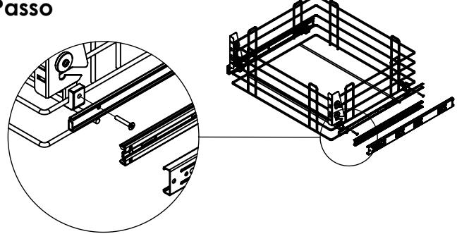
Fixe as Corrediças(B) no 2º arame de baixo para cima utilizando os Suportes(D), as Arruelas(F), Parafusos(H) e Porcas(G).
