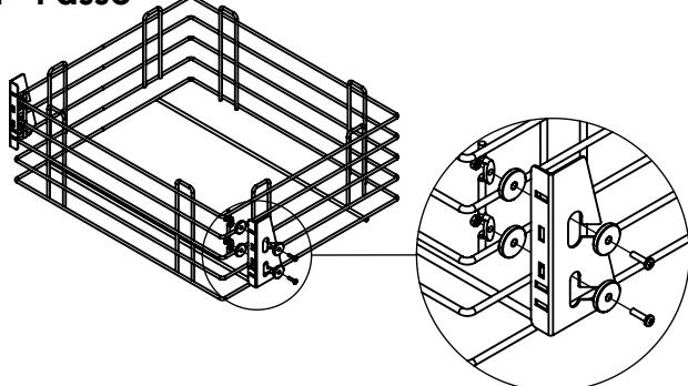
Fixe os Suportes(C) ao Aramado(A) utilizando as Arruelas(E) os Parafusos(I) e as Porcas(G).
