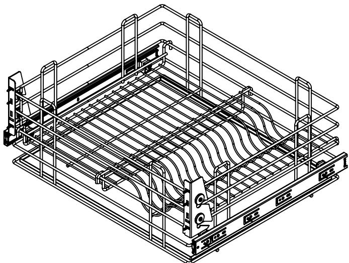
Para modulações com final 70mm, utilize o Suporte "U" com o lado mais fino encostado na corrediça. E para modulações com final 64mm, inverta a posição.
