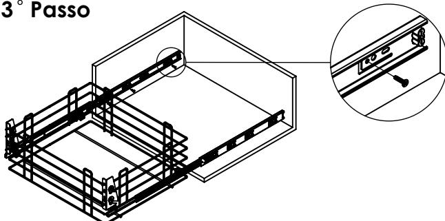
Posicione a Gaveta no local de instalação, alinhando os Suportes "L" com a frente do móvel. Abra as Corrediças e fixe-as no móvel utilizando os Parafusos(J).
