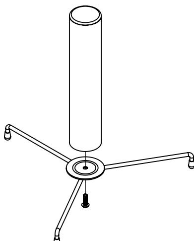
Monte a Base(C) no Tubo Central(D) utilizando o parafuso(E).
