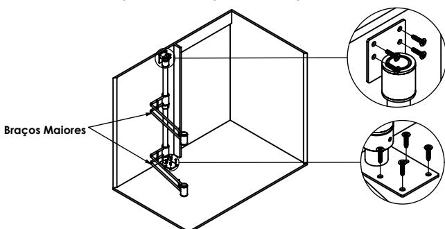
Posicione a Dobiadiça(C) montada com os Braços Maiores(D) na parte interna central do móvel, de acordo com as dimensões de instalação informadas e fixe-a utilizando os Parafusos(L).
