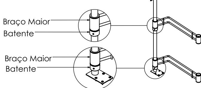
Monte uma das Dobradiças(C), utilizando os Braços Maiores(D), os Suportes Superiores(F),os Batentes(G), os Parafusos(M) e a Chave(N), conforme a sequência e dimensões informadas.
