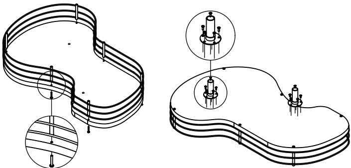
Monte o Aramado(B) sobre a Base(A) e fixe-o utilizando os Parafusos(J).
