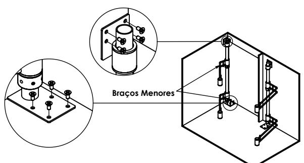
Posicione a Dobradiça(C) montada com os Braços Menores(E) na parte interna lateral do móvel, de acordo com as dimensões de instalação informadas e fixe-a utilizando os Parafusos(L).
