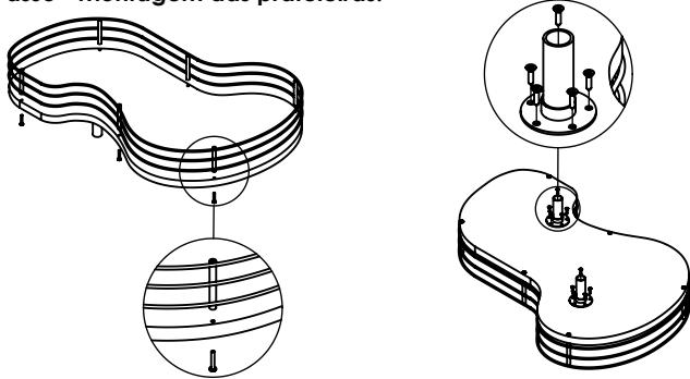
Monte o Aramado(B) sobre a Base(A) e fixe-o utilizando os Parafusos(J). No lado de baixo, posicione os Suportes Inferiores(H) observando a furação pré-existente, fixe o central e depois os demais, utilizando os Parafusos(L).
