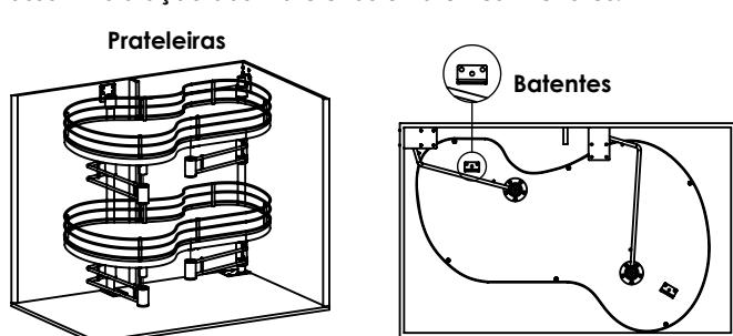
Encaixe as prateleiras nos suportes do braços. Após, movimente as prateleiras para dentro e para fora do móvel e fixe os Batentes Inferiores(I) utilizando os Parafusos(L), de acordo com a amplitude de movimento desejada.
