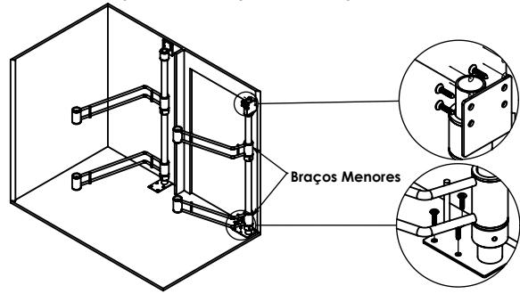
Posicione a Dobiadiça(C) montada com os Braços Menores(E) na parte interna lateral do móvel, de acordo com as dimensões de instalação informadas e fixe-a utilizando os Parafusos(L).
