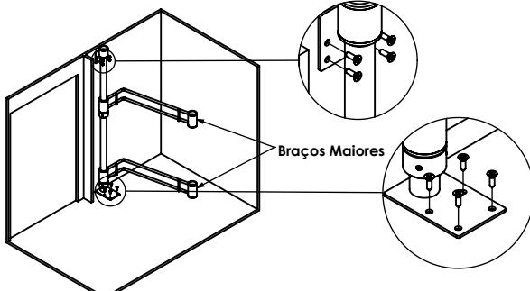
Posicione a Dobradiça(C) montada com os Braços Maiores(D) na parte interna central do móvel, de acordo com as dimensões de instalação informadas e fixe-a utilizando os Parafusos(L).
