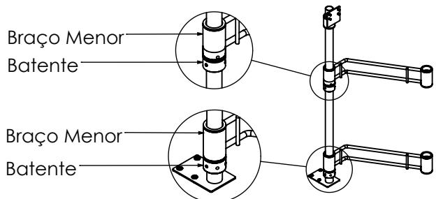
Monte uma das Dobiadiças(C), utilizando os Braços Menores(E), os Suportes Superiores(F), os Batentes(G), os Parafusos(M) e a Chave(N), conforme a sequência e dimensões informadas.
