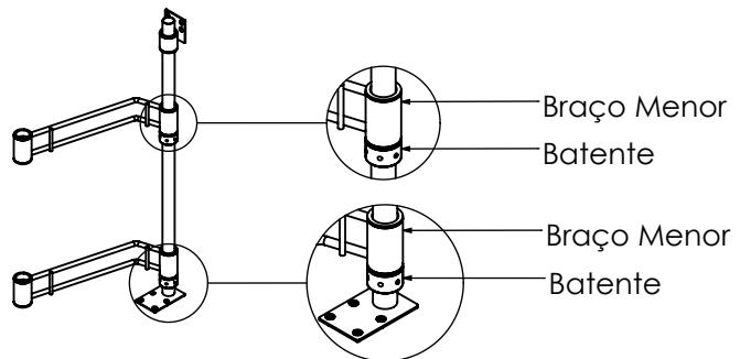
Monte uma das Dobradiças(C), utilizando os Braços Menores(E), os Suportes Superiores(F),os Batentes(G), os Parafusos(M) e a Chave(N), conforme a sequência e dimensões informadas.
