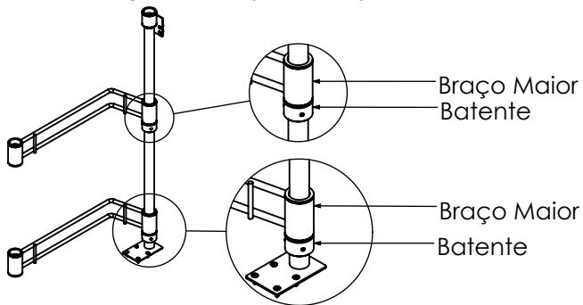
Monte uma das Dobiadiças(C), utilizando os Braços Maiores(D), os Suportes Superiores(F), os Batentes(G), os Parafusos(M) e a Chave(N), conforme a sequência e dimensões informadas.
